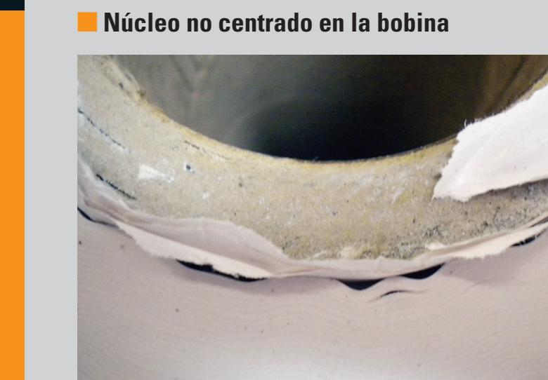
Las arrugas cercanas al núcleo son debidas a baja tensión en el inicio de la bobina en la bobinadora. En la actualidad este defecto es más bien raro y relacionado con cambios de humedad en los núcleos de la bobina antes del bobinado.
