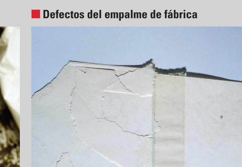
Empalme de fábrica defectuoso: La cinta de empalme se ha situado incorrectamente y se pega al papel que hay debajo. Empalme de fábrica que sobresale: Las bandas no quedan bien alineadas entre ellas y el papel sobresale por el borde de la bobina. Junta de fábrica pegada: La cinta de empalme no ha quedado bien cubierta por el papel y se adhiere a la capa de papel provocando una rotura.
