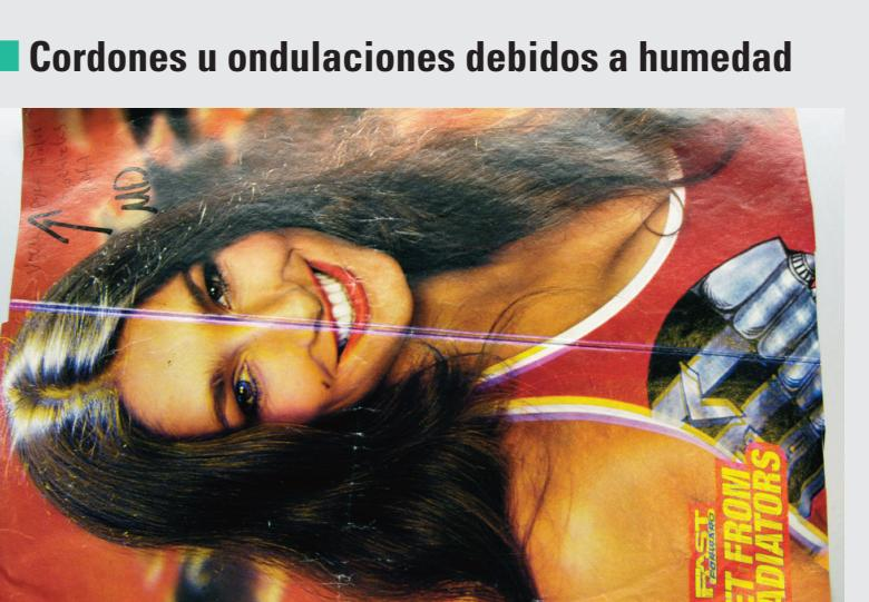
Los cordones que se extienden alrededor de las bobinas en dirección de la máquina de papel, como resultado de la absorción de humedad de la atmósfera. Estas arrugas son causadas por un desequilibrio entre la humedad del papel y la humedad del ambiente que le rodea.
