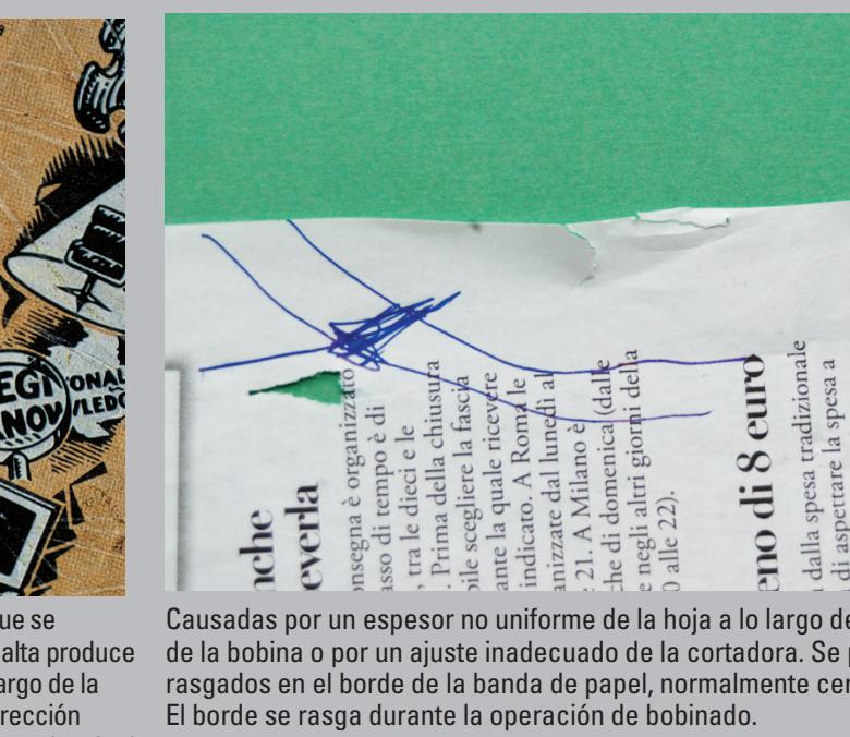
Cuando el cuchillo de la calandria no tiene una velocidad adecuada para la tasa a la que se aplica un corte, se produce un pliegue o rizado en la banda de papel. El corte normalmente tiene dirección diagonal con respecto a la dirección de la máquina. A menudo existen cortes en línea; normalmente tienen una longitud de 5-8 cm (2-3") y pueden tener bordes aplastados, satinados o decorados. El borde se rasga durante la operación de bobinado.
