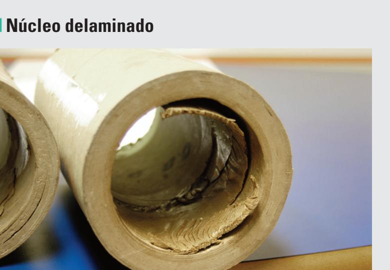
La delaminación del núcleo puede ser causada por poca presión de los conos de expansión o por haber puesto o sacado la bobina varias veces en la rotativa o por un núcleo de baja calidad o de tipo erróneo.
