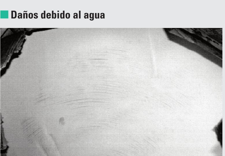
Cuando existen áreas saturadas y se secan, una o más capas de la bobina se pegar entre ellas. Este defecto no siempre es visible en el envoltorio pero puede observarse en forma de pequeños huecos en las capas de la bobina (tenga cuidado de no confundir este defecto con el de cola en los laterales de la bobina).
