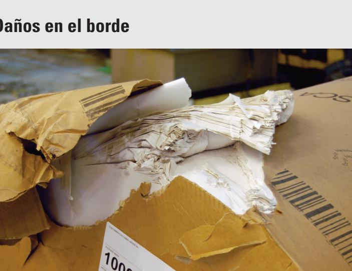
La bobina ha estado descansando o empujada donde había piedras u otro material, durante el tránsito; o se ha colocado sobre el suelo en una posición inclinada.
