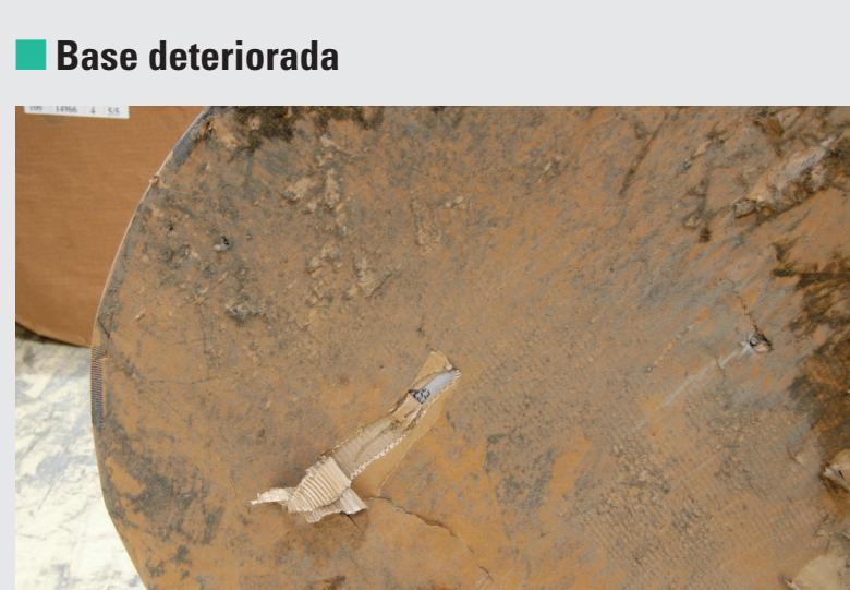
Rasgo o muescas en los extremos o lados de la bobina provocados en el almacenamiento al apoyar ese lado sobre una superficie suelta o rugosa; o también al pasar esa superficie sobre superficie no uniforme.
