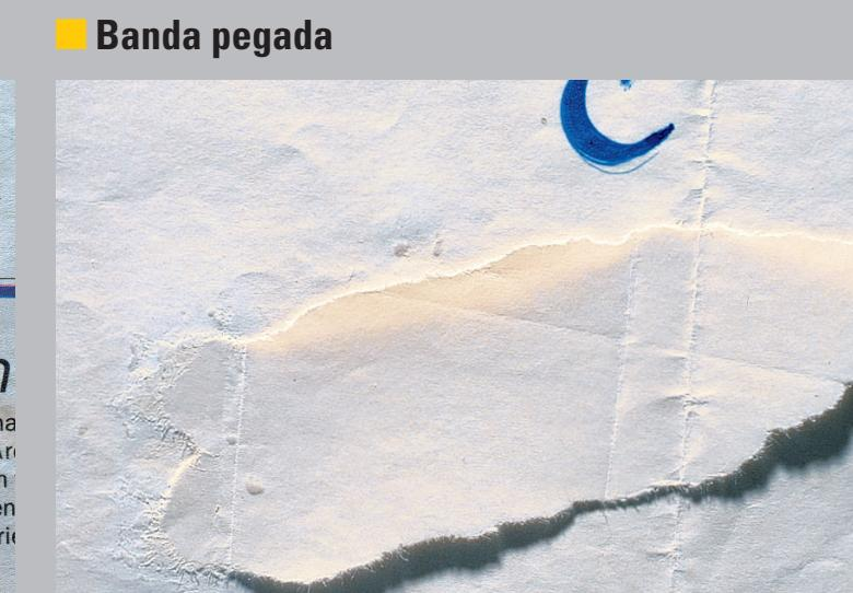
Este puede ser causado por agua que cae en la superficie del papel después del procesamiento de la máquina o por un exceso de estuco. Cuando estas áreas se secan una o más capas de papel se pegar entre ellos.
