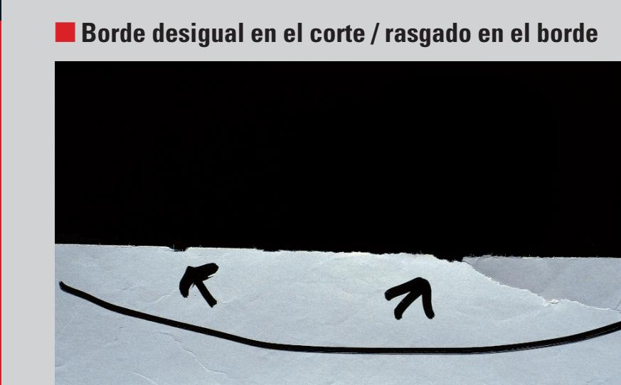
Normalmente es consecuencia de una cuchilla gaseada o mal colocada en la cortadora que produce un borde de la bobina con un aspecto desigual. Un borde defectuoso que produce una banda de la bobina puede generar un borde irregular o hasta del papel.
