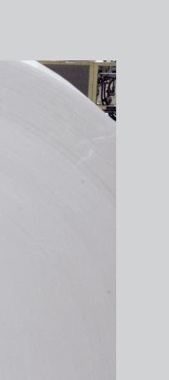
Falta de uniformidad en el espesor y la humedad a través de la banda y excesiva tensión en las áreas de mayor espesor durante el bobinado.
