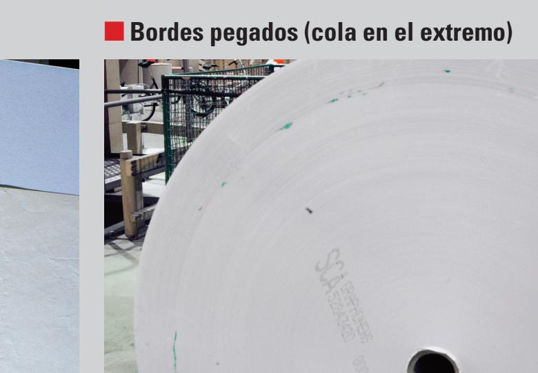
Este defecto tiene como causa un fallo en el proceso de empalme permitiendo que la cola entre en contacto con el extremo de la bobina; también puede ser debido a penetración localizada de agua del envoltorio provocando algunas zonas en las que las capas de papel se peguen entre sí.
