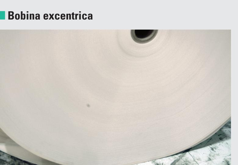
Debida a algún impacto duro durante el transporte, almacenamiento horizontal prolongado o excesiva presión de las palas de la carretilla elevadora.
