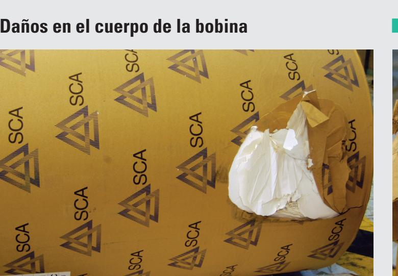
Perforación del envoltorio y del propio papel debido a un manejo defectuoso (arrastres, impacto contra un objeto puntiagudo, procedimiento incorrecto con las mordazas de la carretilla elevadora).
