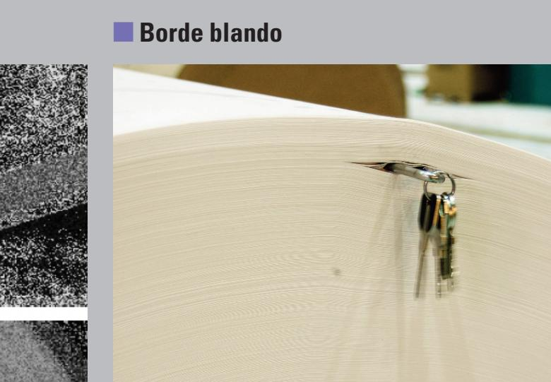
Las variaciones de espesor a lo ancho de la bobina generan un borde de la bobina con sensación de "blando" en relación con áreas adyacentes.
