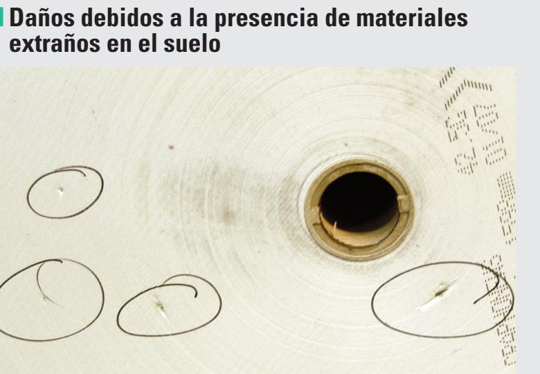
Muesca en el borde de la bobina. Normalmente se resuelve eliminando la parte dañada.
