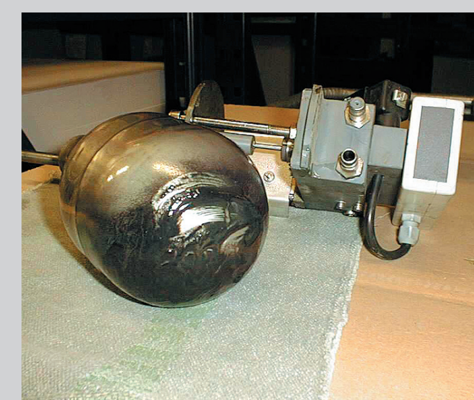
Les saletés accumulées sur le flotteur de stabilisation d'alcool augmentent son poids et peuvent modifier la teneur en alcool de la solution de mouillage. Photo Technotrans.
