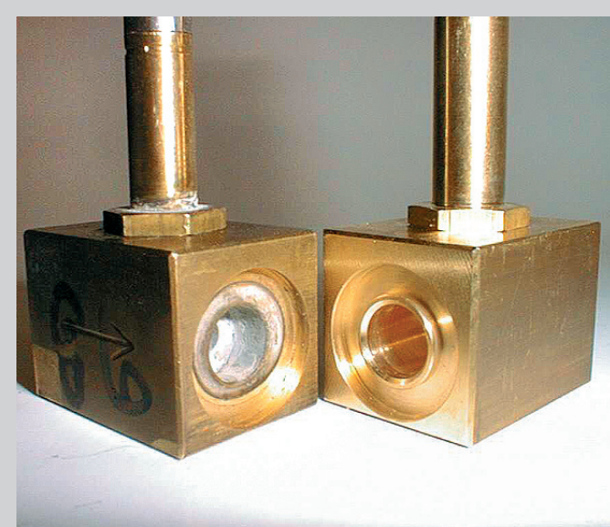
Corrosion de pièces mécaniques due à l'emploi d'additifs inadaptés ou agressifs ou d'alcool de mauvaise qualité. Photo Technotrans.
