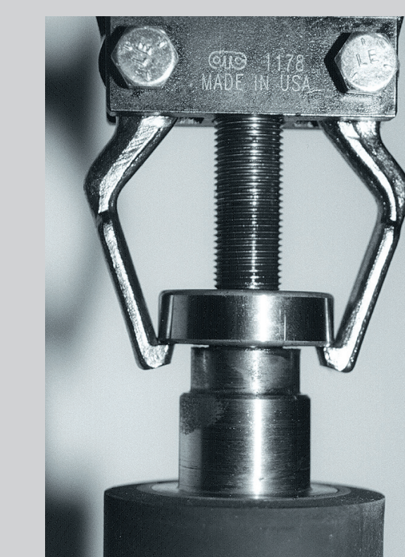
Toujours utiliser les outils adéquats pour garantir un ajustement aisé et correct. Photo Böttcher.
