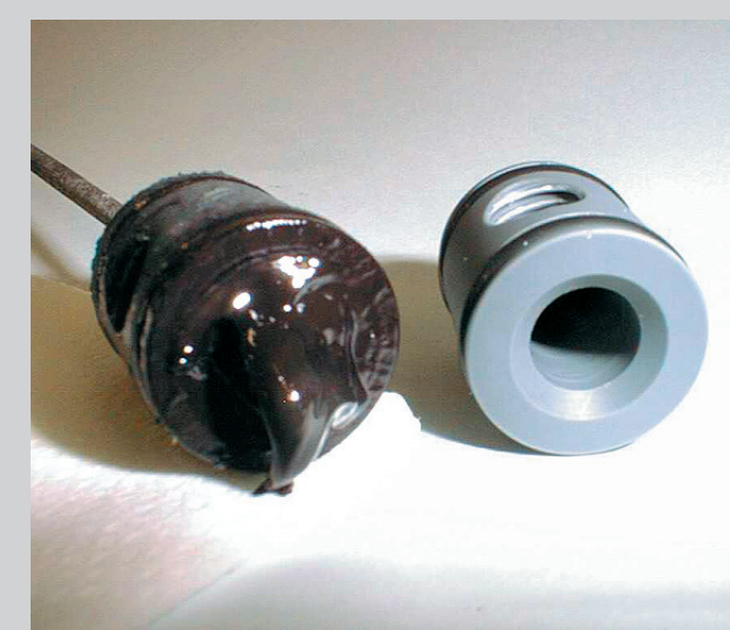
Buse d'injecteur contaminée par l'encre suite à l'utilisation d'un filtre inadapté ou à défaut de maintenance. Photo Technotrans.
