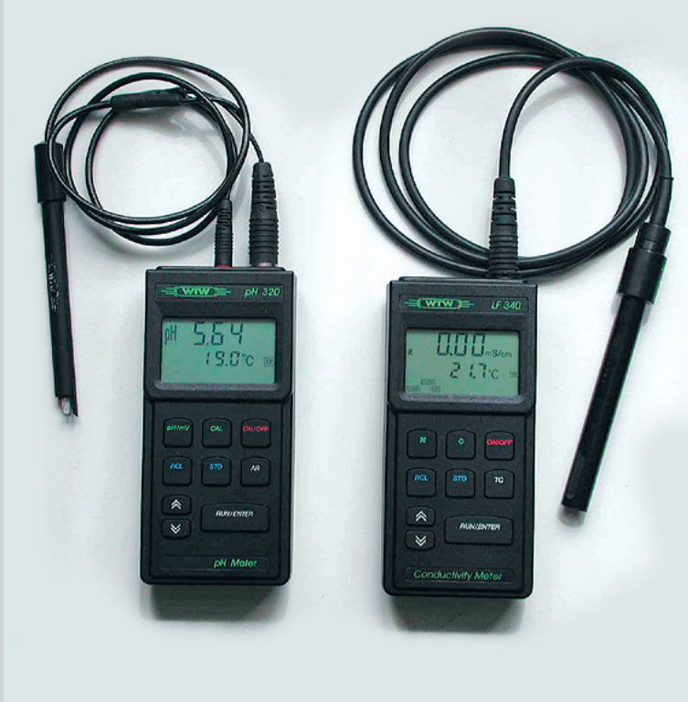
Les outils de contrôle de la solution de mouillage comprennent les conductimètres numériques, les pHmètres et les thermomètres (les outils numériques sont plus précis et plus faciles à calibrer), ainsi qu'un hydromètre pour mesurer le pourcentage d'alcool isopropylique, et enfin, un appareil de mesure de la dureté de l'eau. Photo Sun Chemical.
