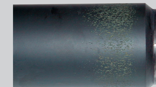
Rouleau endommagé suite à un défaut de montage ayant entraîné une augmentation de la température de fonctionnement. Photo Böttcher.
